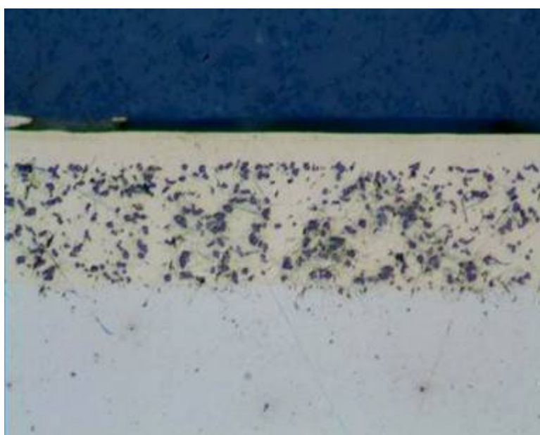
Obr. 1: Funkční povlak Ni-diamant na oceli, zvětšeno 500 x
