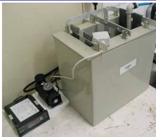
Obr. 2 Pracoviště pro tvrdou anodickou oxidaci hliníku
