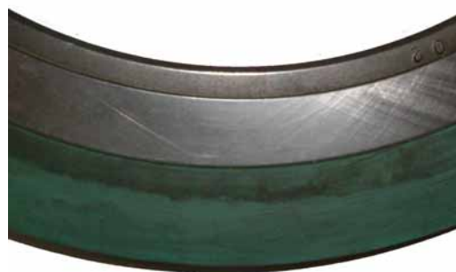
Obr. 2. Výřez z nevyčištěného gumového vymezovacího kroužku pro dělicí nože
