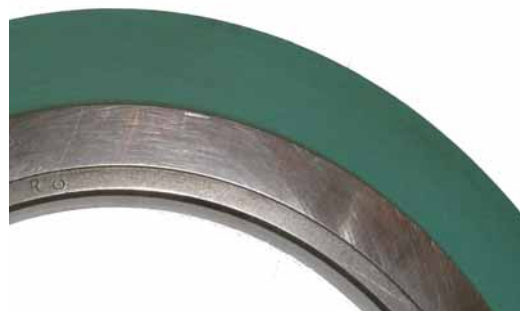
Obr. 3. Výřez z vyčištěného gumového vymezovacího kroužku pro dělicí nože
