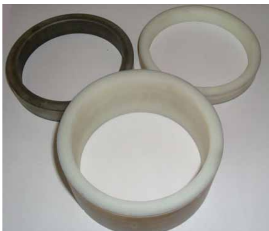
Obr. 1. Celkový pohled na vyčištěné silikonové vymezovací kroužky a nevyčištěný silikonový vymezovací kroužek
